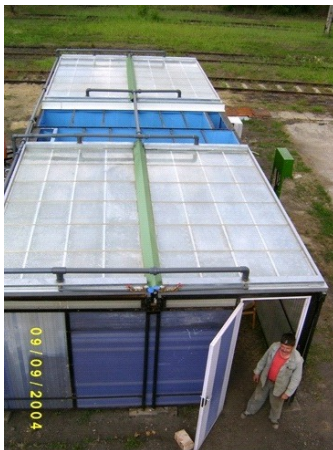
2. ábra: Napenergiát hasznosító víztisztító Hidas külterületén.
