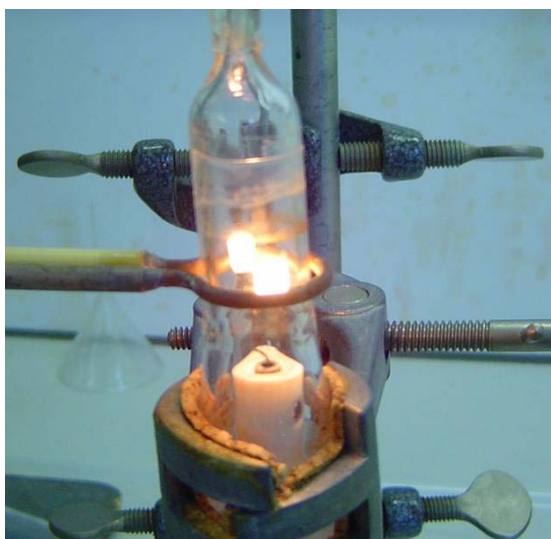
3. ábra Iridium egykristány előkészítése méréshez: 2000 Co-os hevítés argonáramban
